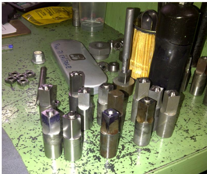
Figura 13 - Detalhe das ferramentas utilizadas na estampagem das porcas
